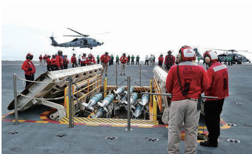
“福特”号航空母舰弹药升降机的飞行甲板出口。
