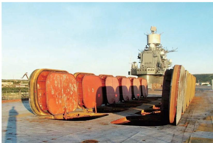
/ 位于滑跃甲板下方的 SS-N-19“花岗岩”超音速反舰导弹发射井。
