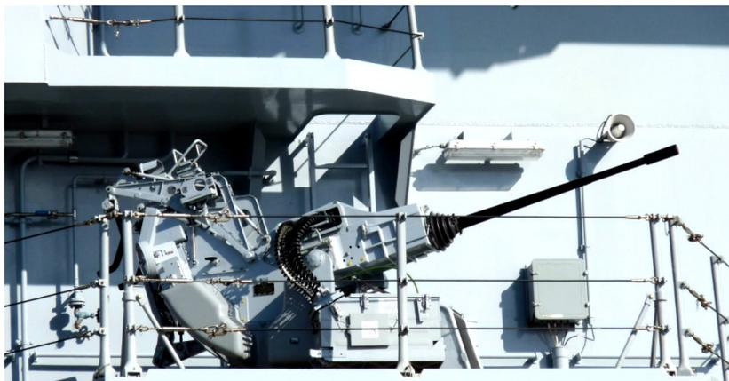
/ “奥托 梅莱拉” KBA 型 25 毫米近防炮。
