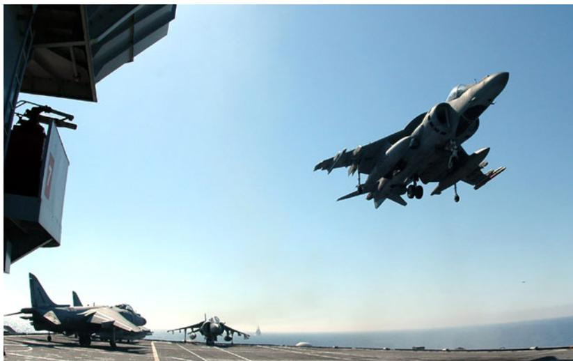
/ AV-8B 舰载机正在垂直降落。
