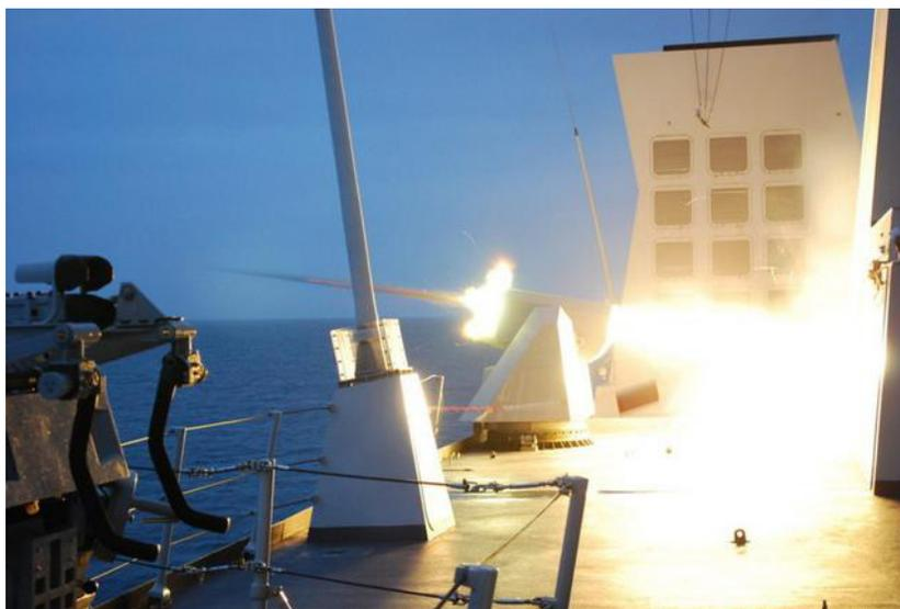
/ SCLAR-H 反导诱饵火箭发射装置正在测试。
