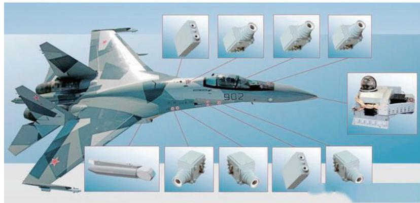
/ OLS-35 光电探测系统的各型传感器位置示意图。
