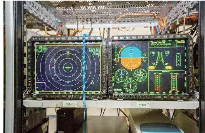
/ 正在实验室测试的核心计算机系统。
