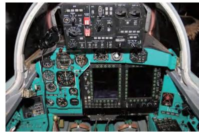
/ 米格-31BM战斗机的后部系统操作员座舱。
