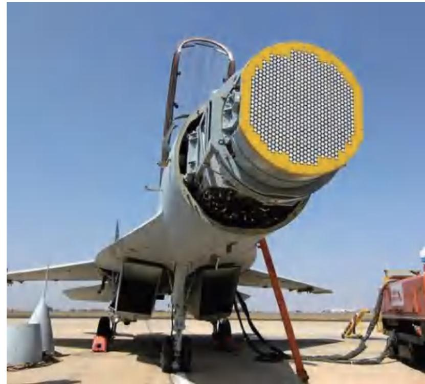
/ 米格 -29K / KUB 装备的“甲虫 -AE”FGA-29 型相控阵雷达。
