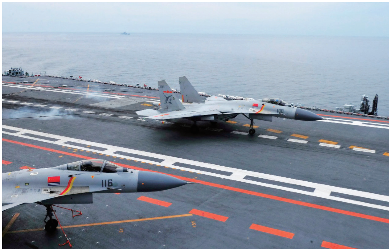
/ 飞机降落甲板时拦阻设备“拖拽”住飞机尾部。
